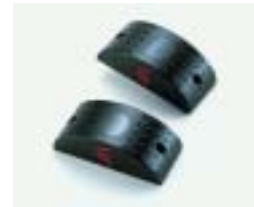
CELLULA130: Lichtschrankenpaar Sender / Empfänger. Reichweite bis max. 30 m. Versorgungsspannung: 24 Vac Waagrechte oder senkrechte Montage möglich
