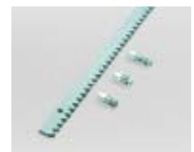
CVZ: Eisenzahnstange 30x12, Modul 4, verzinkt mit Langlöchern, 1 m - Stücke Höchstbelastung 2000 Kg.
