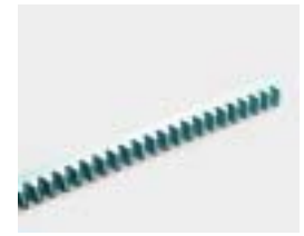
CFZ: Eisenzahnstange 22x22 Modul 4, verzinkt, 2 m-Stücke, zum anschweißen. Höchstbelastung 2000 Kg.
