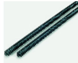
CP: Kunststoffzahnstange 22x22 Modul 4 aus hochfestem Kunststoff und Stahlkern 8x8 mm. (1m-Stücke) Mit Langlöchern. Höchstbelastung 500 Kg.
