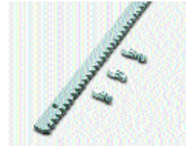
CVZ: Einsenzahnstange 30x12 Modul 4 verzinkt mit Langlöchern (1m-Stücke). Höchstbelastung 2000 Kg.
